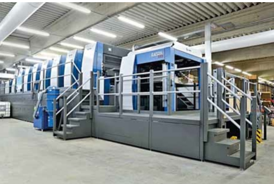
La máquina está elevada 630 mm y se ajusta exactamente a las necesidades de la producción de envases
