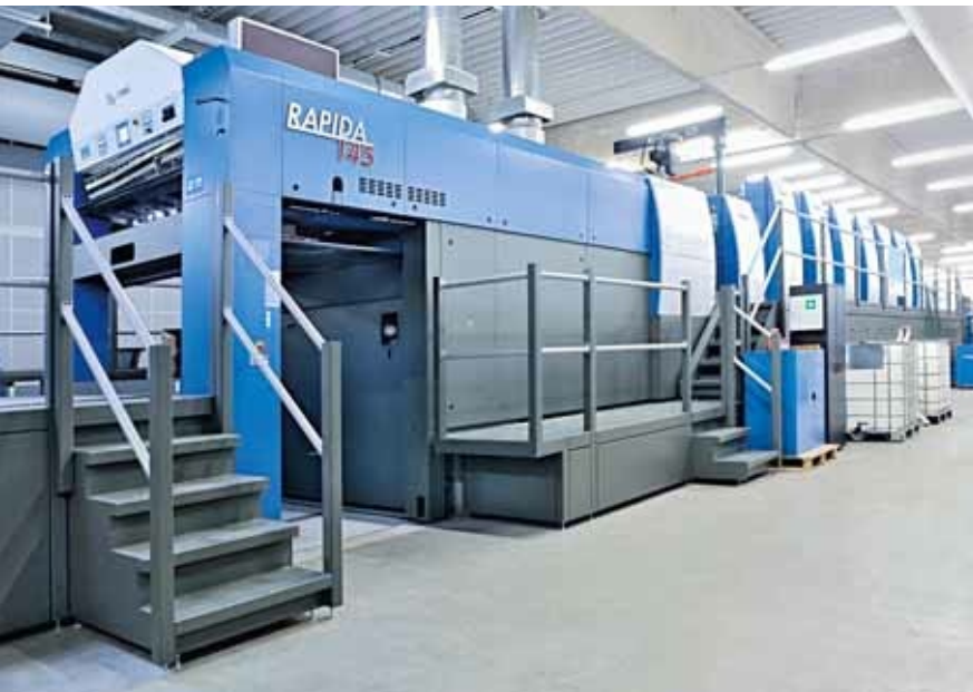
La Rapida 145 de siete colores con torre de laca es el corazón productivo de la moderna nave de fabricación en Pokart
