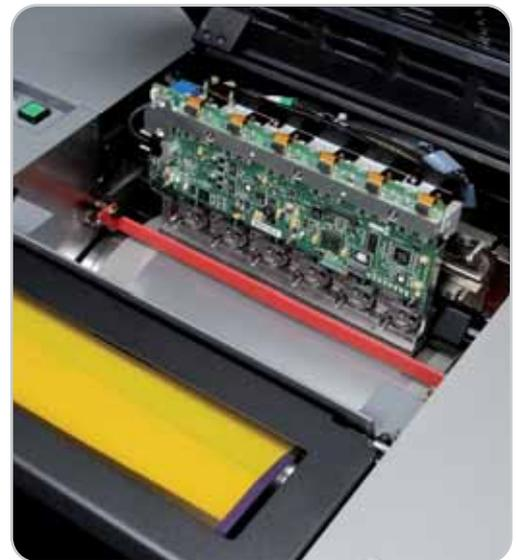
La Presstek 34DI incorpora 6 diodos láser multihaz en cada uno de sus módulos de exposición.
