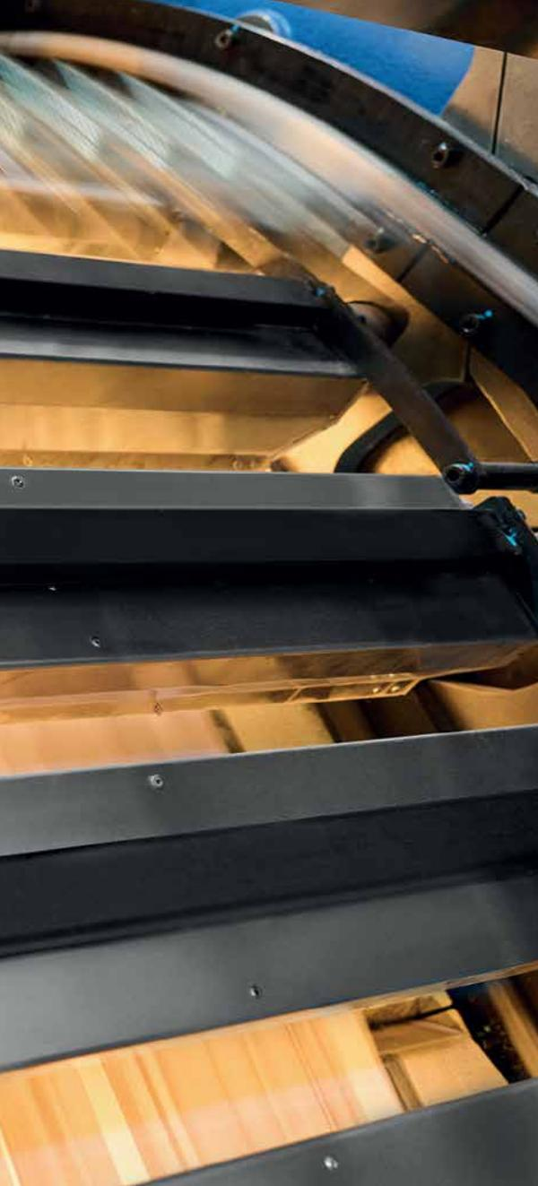
Junto con los secadores IR/TL clásicos, hay disponibles sistemas UV, HR-UV y LED-UV. Tienen en común que todos poseen una estructura modular y que se ajustan a la perfección al recorrido del pliego en la máquina.
