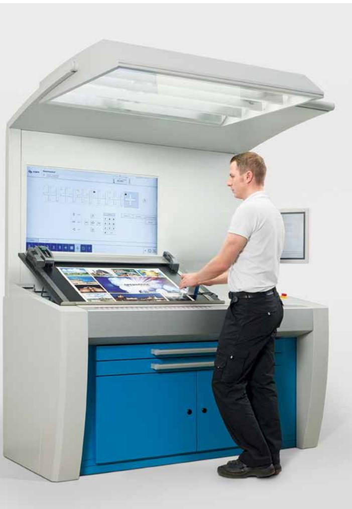
Las pantallas táctiles con botones de selección rápida en el marcador y la salida garantizan una comodidad de uso adicional, directamente en la máquina. La Rapida 76 dispone adicionalmente de componentes personalizados de flujo de trabajo para la integración de sistemas internos de control y gestión de la producción.
