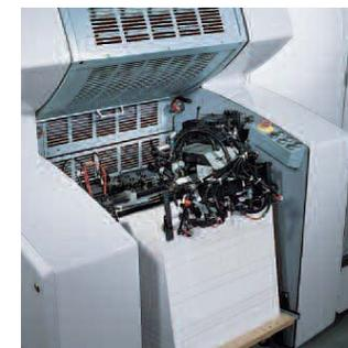
La calidad empieza en el alimentador, con una precisión constante en el adaptador, como el control de doble hoja, mesa de cintas de aspiración y aspiradores combinados de arrastre / separación
