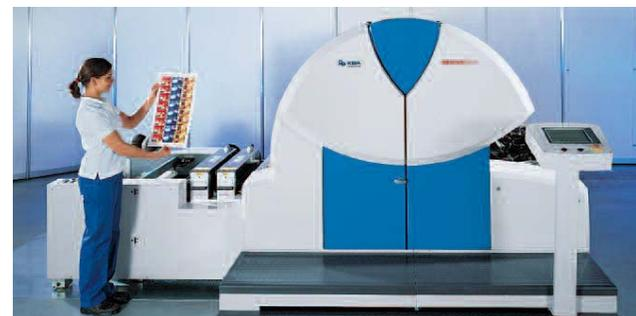
Diseño compacto con elevado ahorro de espacio, en sólo 12 m<sup>2</sup>. Un óptimo manejo ergonómico de la Genius 52UV gracias a su pantalla con panel táctil flexible situado lateralmente frente a la máquina
