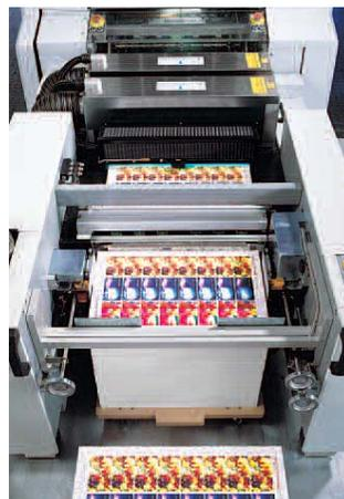
Genius 52UV con salida ampliada y sistema de secado UVA integrado
