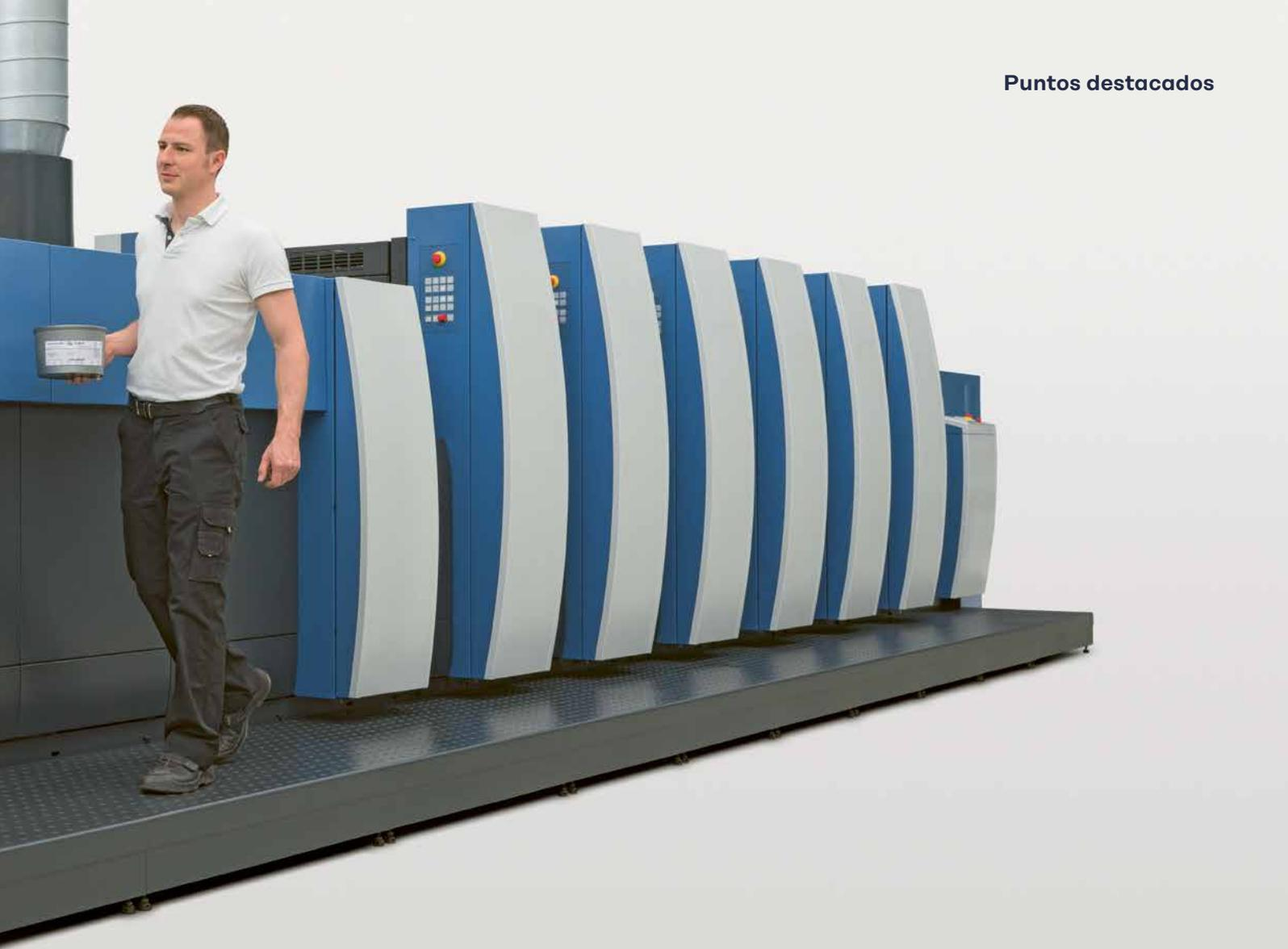
Paralelamente, la Rapida 75 PRO se caracteriza por su nuevo concepto de manejo. El puesto de mando ErgoTronic con manejo TouchTronic ahora también está incluido en el equipamiento básico de la Rapida pequeña. De este modo, desaparece la separación existente hasta la fecha entre la pantalla de la salida para el manejo de la máquina y el puesto de mando para la gestión de los trabajos.
