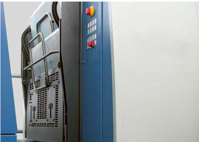
En función de los requisitos de su producción, puede elegir entre el cambio automatizado de planchas de impresión con SAPC o FAPC para el cambio totalmente automático.
